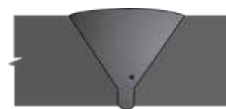
39 Porosity in Fillet (sub-surface) UT, RT
