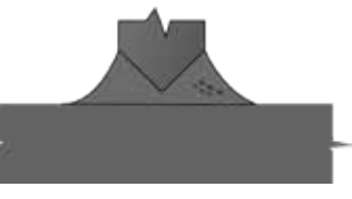
31 Porosity in Fillet (sub-surface) UT, RT
